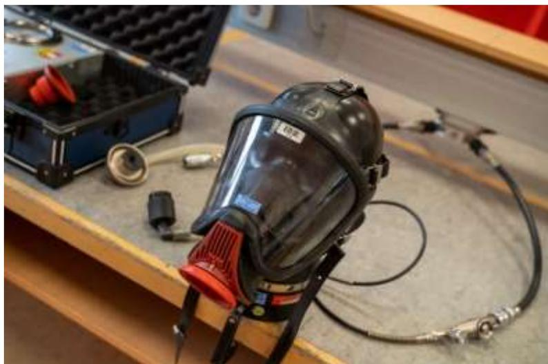
Abb. 22: Maske am Prüfkopf angebracht
