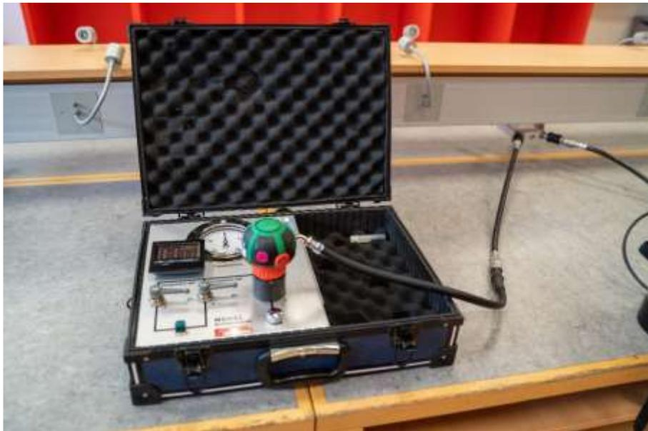
Abb. 24: Lungenautomat mit Mitteldruck-Prüfleitung verbunden und am Prüfkoffer angebracht
