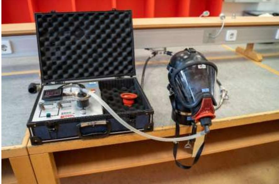
Abb. 23: Maske über Prüfleitung mit Prüfkoffer verbunden
