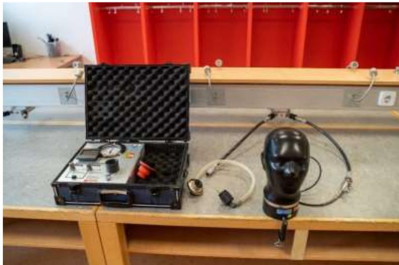
Abb. 21: Vorbereiter Prüfkoffer mit Prüfkopf in „Kopfform“
